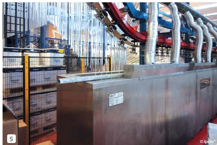
(San Bonifacio, Verona) para limpar os ganchos sem ter que removê-los do transportador e enviá-los para uma empresa externa (**fig. 5**). O sistema consiste em um tanque com produto de decapagem posicionado entre as estações de carga e descarga dos perfis. No percurso de uma estação para outra, o gancho, pendurado na correia, mergulha no tanque de pintura e permanece ali por cerca de 3 minutos, saindo sem acúmulos de tinta que afetam a eletrostática durante a aplicação.
