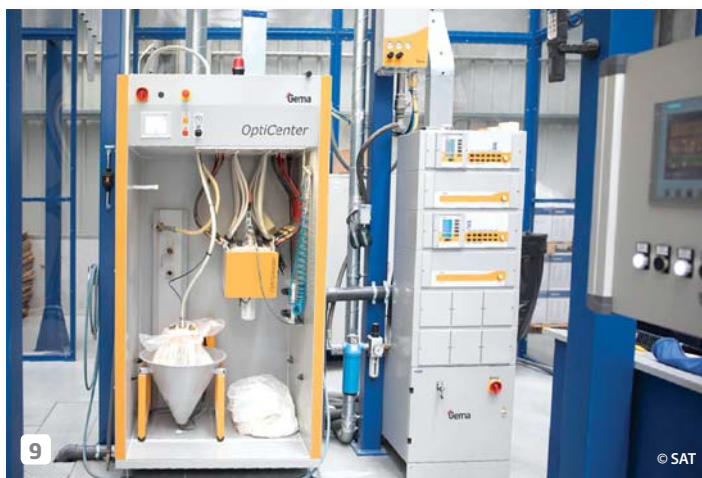
9 Las centrales de polvo OptiCenter de Gemma permiten cambios de color muy rápidos.
