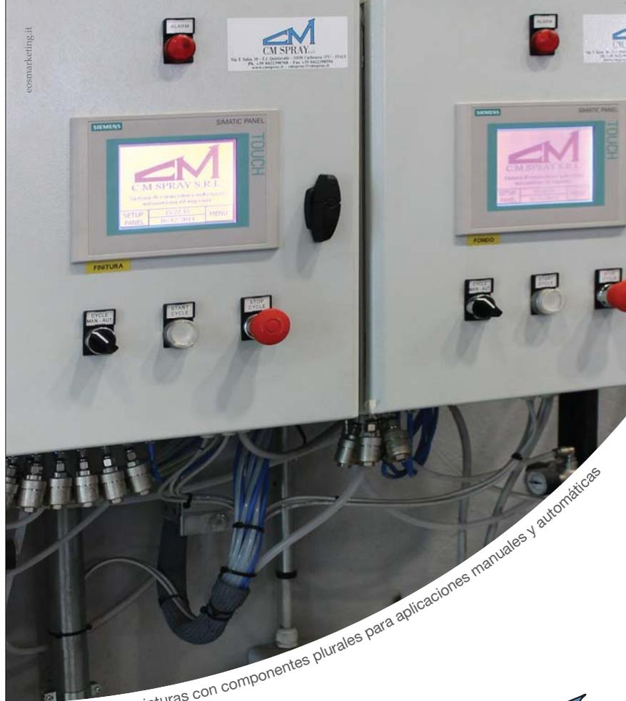
Dosificador de pinturas con componentes plurales para aplicaciones manuales y automáticas
