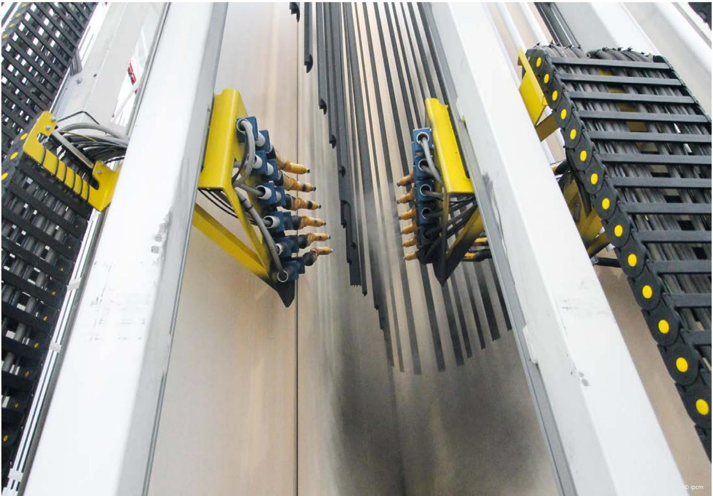
**La cabina V-Shape de SAT con 24 pistolas automáticas OptiGun.**
