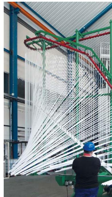
mayor penetración y estabilidad de las pinturas que se aplicarán posteriormente, al mismo tiempo que se proporciona también una protección adecuada al metal. El último paso antes de pintar consiste en lavar con agua desmineralizada y secar en el horno para que los perfiles lleguen secos a la cabina de pintura".
